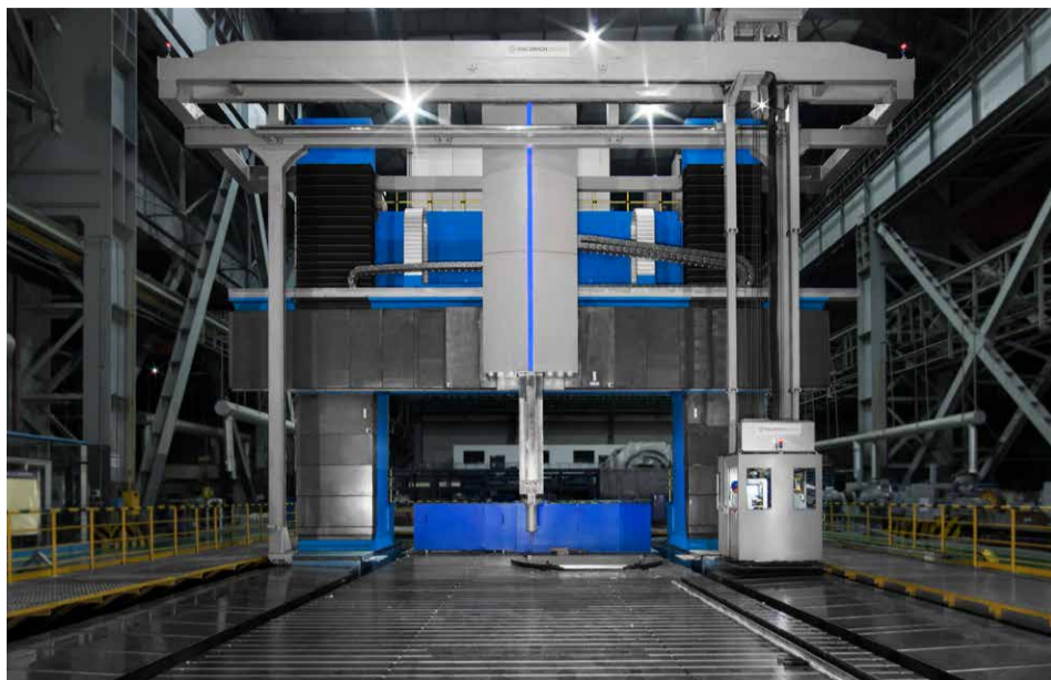
Впечатляющая зона обработки в 7.776 м 3 : станок ProfiMill
