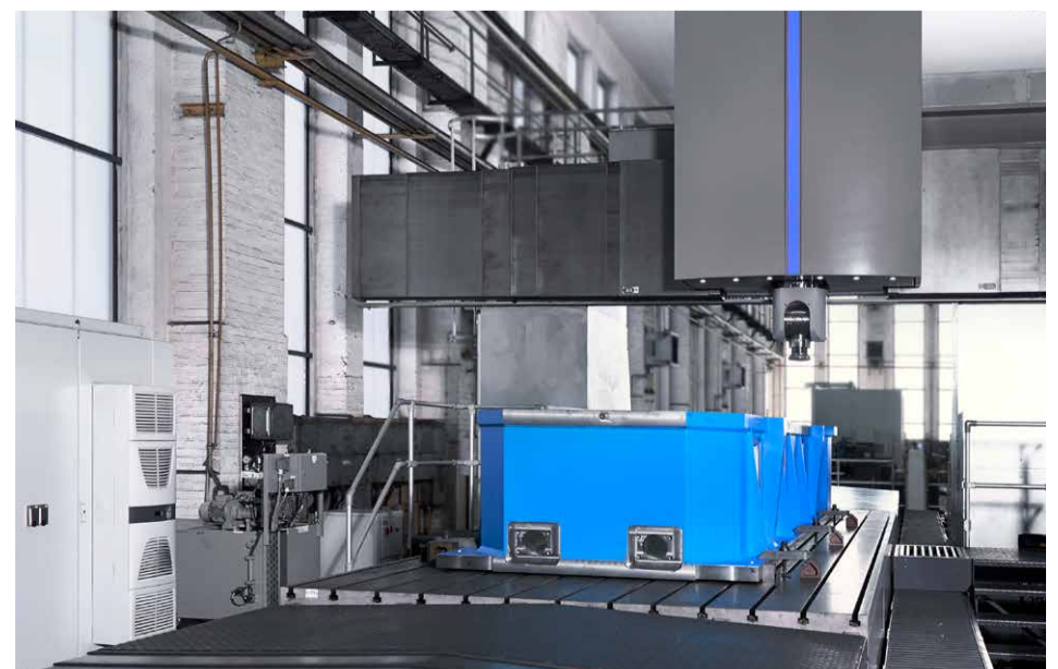
ProfiMill compact обрабатывает корпус XXL — передачи вертолетного испытательного стенда
