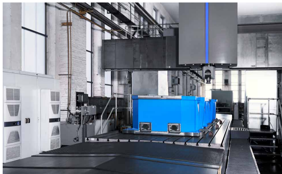
ProfiMill типоразмера 1: компактный станок для обработки малых и среднегабаритных деталей
