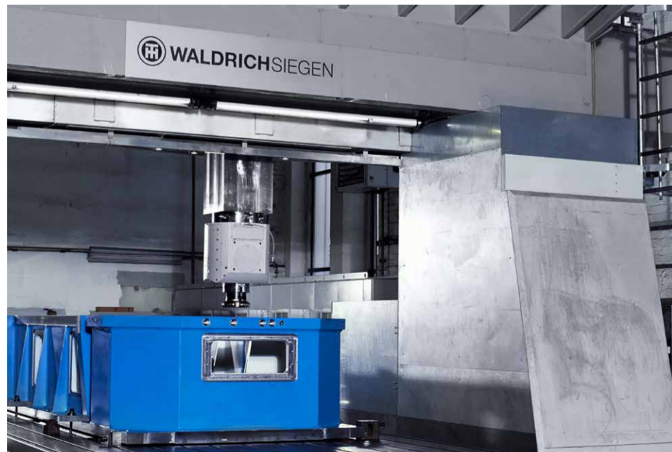
Опция с бетонной стойкой повышает последующую жесткость станка
