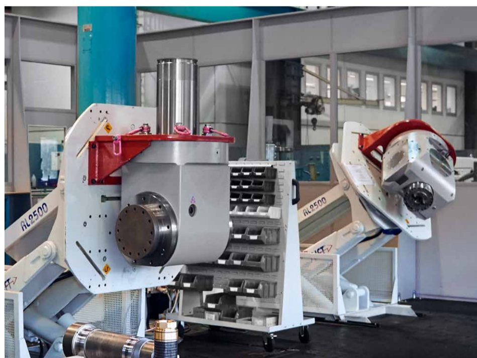
Точная подгонка под запросы заказчиков: фрезерные головки собственного производства
